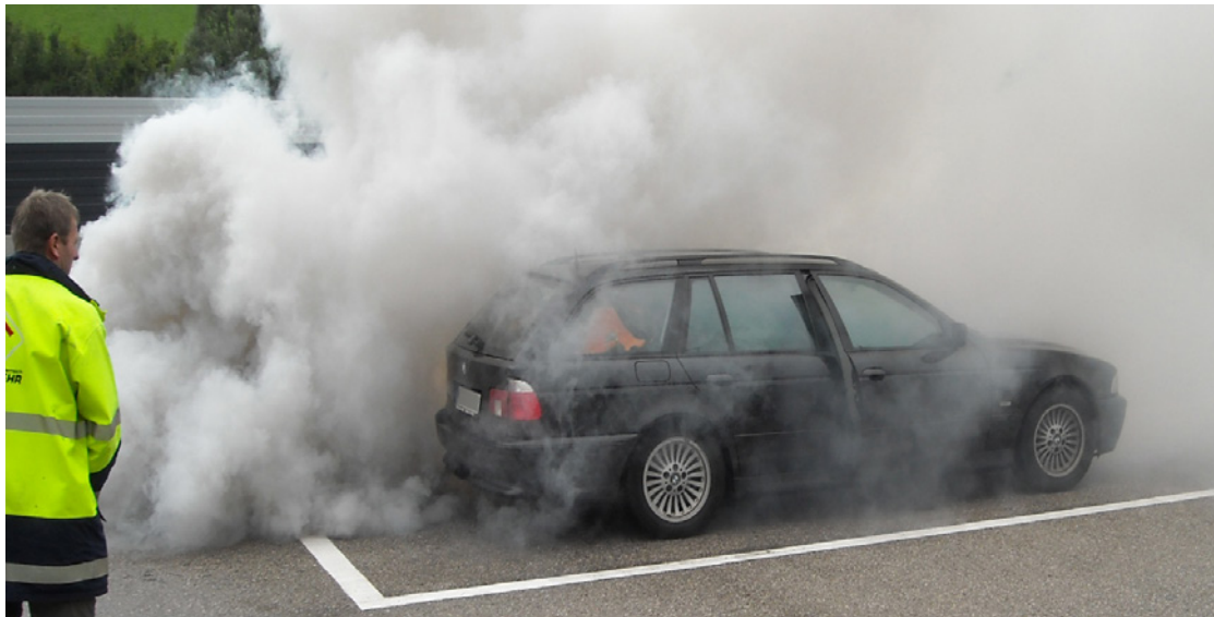
Prüfung an Ort und Stelle – Fahrzeug mit defektem Turbolader
